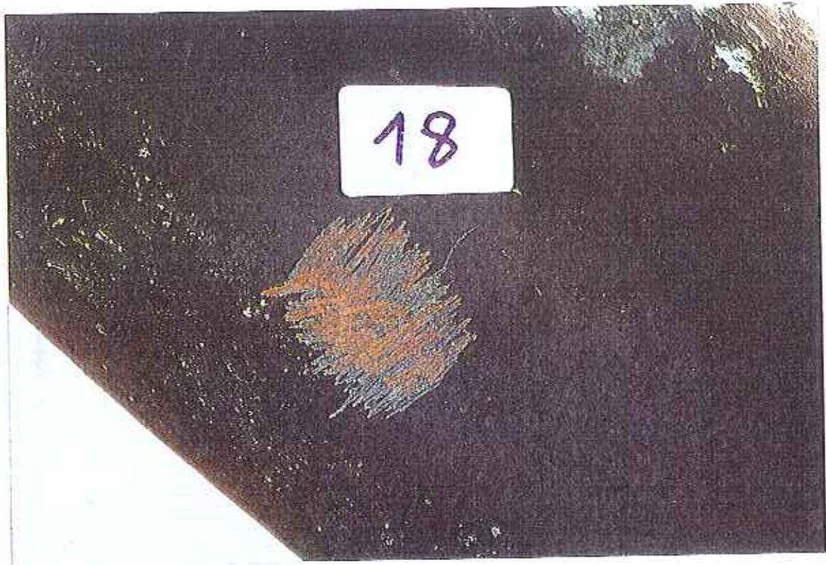
Fig. A16 – Estátua de D. José I .Subcamada de produtos cor-de-laranja, visível após remoção da camada exterior de patina preta.
