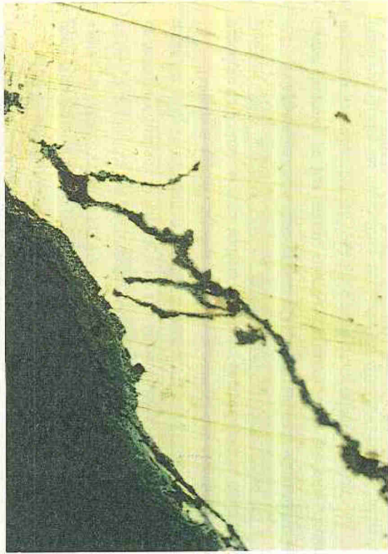
Fig.9 - Amostra 10. Pormenor da liga e da patina observado no MO. (A=150X)
