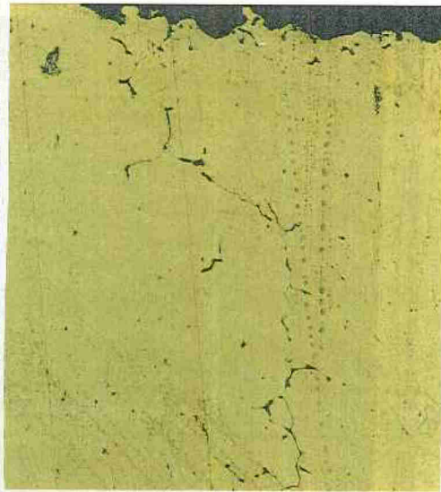
Fig.17 - Amostra 11. Pormenor da liga apresentando corrosão generalizada e da patina.
