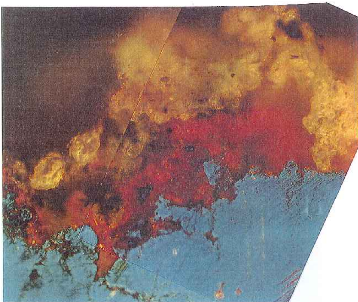
fig.33 - Amostra 38. Aspecto micrográfico da patina, observado numa secção transversal ( \Lambda=125X ).
